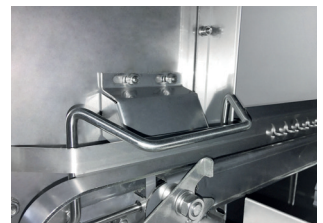
自动启动/停止装置, 降低能耗
